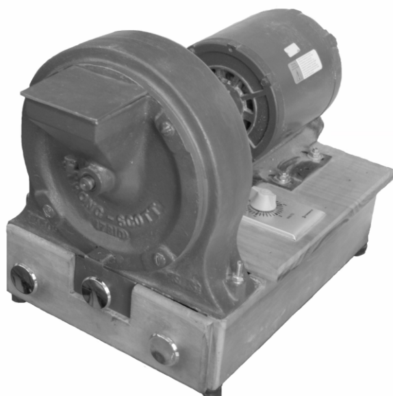
Рис. 8. Лабораторная крупорушка (burrows electric barley pearler. Seedburo Equipment Company). Минимальная навеска 50 г зерна.
